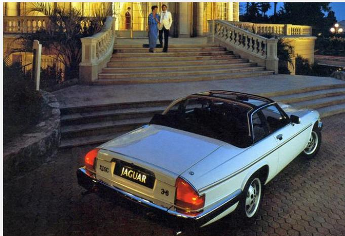
Aber statt eines vollwertigen Cabriolets mit faltverdeck wie beim E-Type wehte nur noch ein laues Lüftchen durch die umständliche Konstruktion: die offene Version des Jaguar XJ-S verfügte über ein zweigeteiltes, herausnehmbares Dach, einen Überrollbügel auf Höhe der B-Säule und ein klappbares Stoffverdeck für den hinteren Teil.
