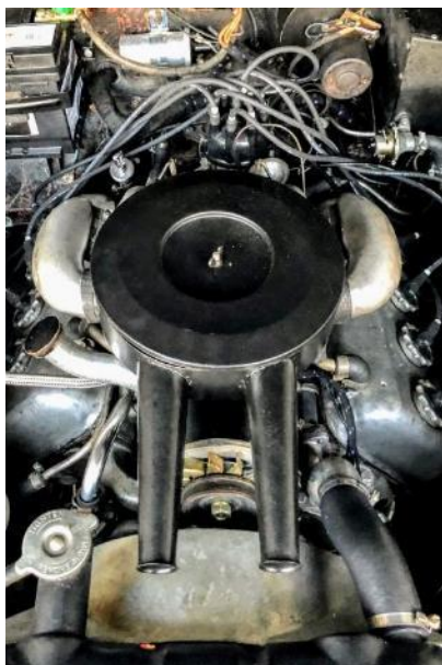
Der sanft blubbernde Achtzylinder V-Motor mit 2,5 Liter Hubraum leistet 140 PS
