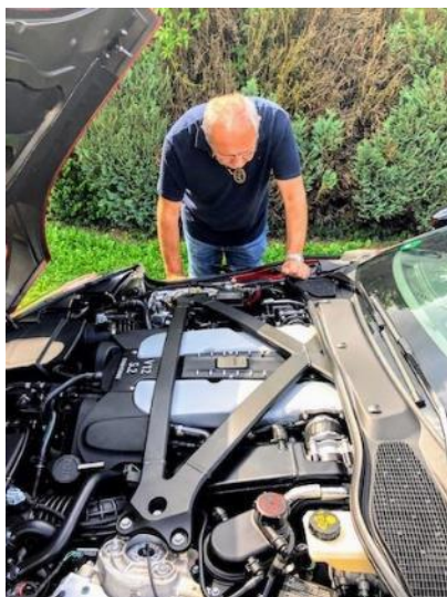
Mr. Black erkennt mit geschultem Blick: der 5,2-Liter V12-Zylinder Bi-Turbo Motor hängt hinter der Vorderachse als Mittelmotor
